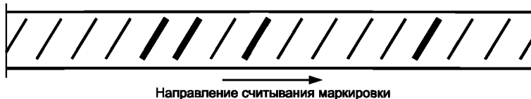
Рисунок 2 — Пример прокатной маркировки предприятия-изготовителя под номером 14
